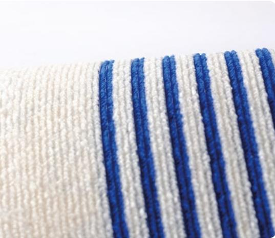
La technologie S.Café® utilise une température basse, une haute pression et un process qui consomme peu d'énergie, pour allier le marc de café à la surface du fil. Ce fil certifié cradle to cradle offre jusqu'à 200 % de rapidité de séchage comparé à une fibre coton. L'ULTIMATE 3D S.Café®, développée sur base 100 % polyester est recyclable et ses 50 lavages de durée de vie sont garantis dans les conditions les plus extrêmes (utilisation de Javel, haute température de lavage ou de séchage, etc.).
